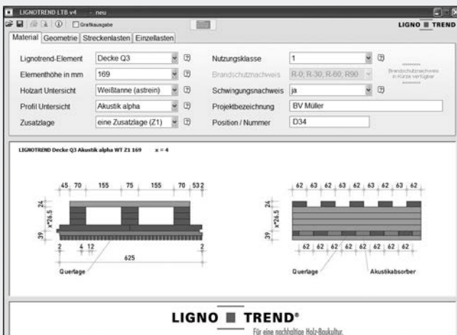
Justificatif d'essai de toutes les éléments de dalles / de toit selon les eurocodes 5.
