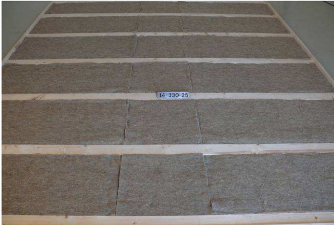
Bild 1: Rahmenkonstruktion mit Bedämpfung
