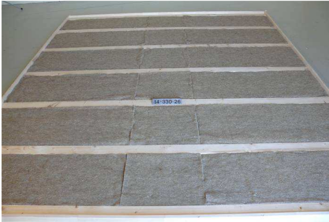
Bild 1: Rahmenkonstruktion mit Bedämpfung
